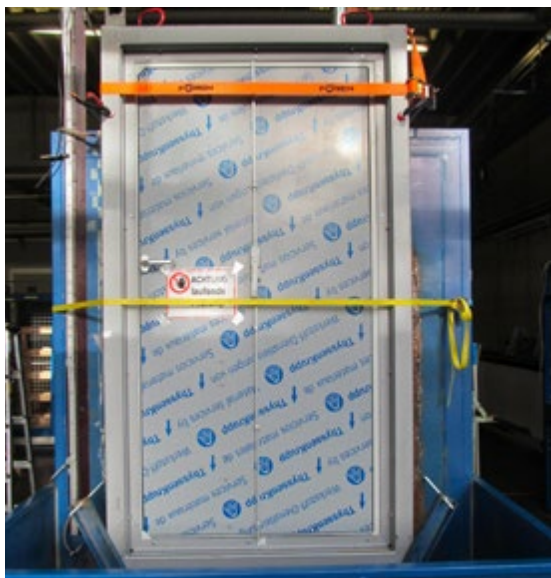
IFT-test AquaLOCK® Deur, 3.000 mm / 5.000 mm hoogte gedurende 24 uur.
